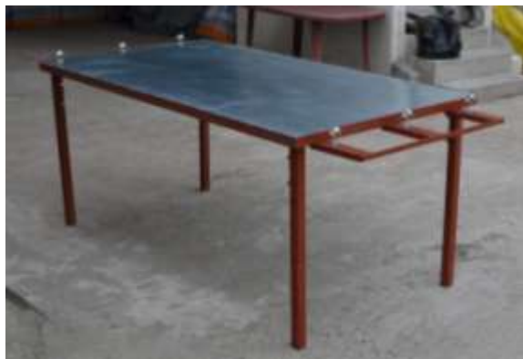
Slika 3: Sto za lemljenje, za povezivanje pojedinačnih apsorberskih traka u jedan cijeli apsorber
