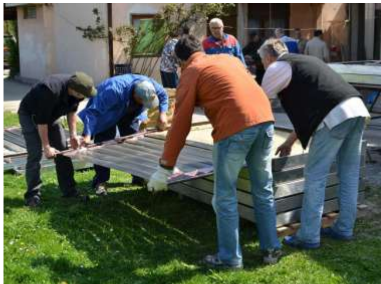
Slika 7: Ugradnja apsorbера u izolirani kolektorski okvir
