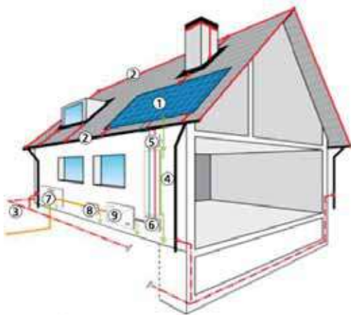
Slika 11.30: Vanjska gromobranska zaštita i izjednačenje potencijala
