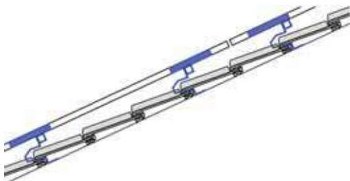
Slika 5.18: Kleme modula se mogu ugraditi kako je odredio dobavljač modula (plavo područje)
