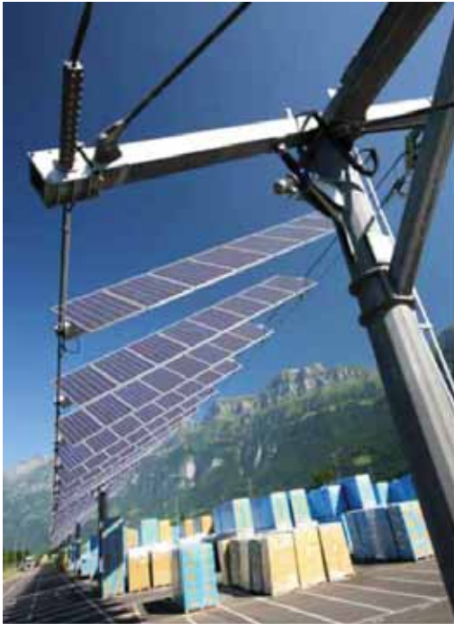
Slika 10.15: Kablovski sistemi (sa užadima) mogu pratiti sunce po uzdužnoj kao i po poprečnoj osi
