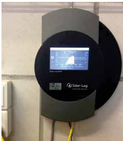
Slika 3.23: Primjer upravljačke jedinice za nadzor sistema sa odvojenom registracijom podataka
