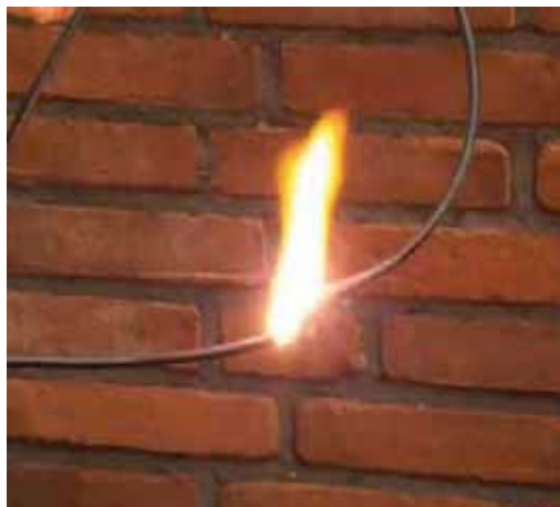
Slika 11.35: Električni luk između dva DC kabla
