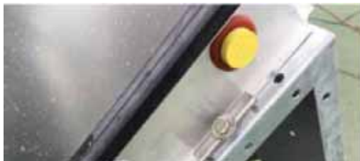
Slika 8.1: Bočno fiksiranje kolektora
