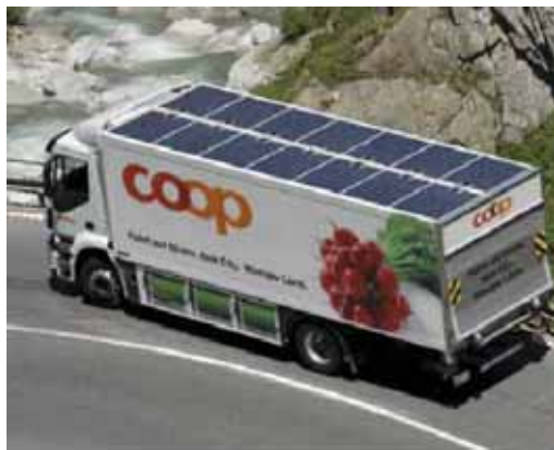
Slika 10.19: Otočni/Off-grid sistem za rad rashladne jedinice
