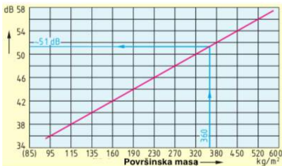
Ovisnost mjere zvučne izolacije i mase
