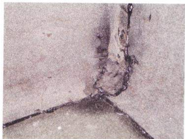
Izbočeni ugao Prvi sloj varenjem završen
