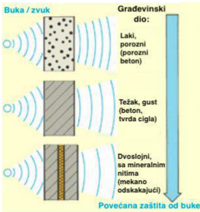
Zvučna zaštita različitih vrsta zidne gradnje
