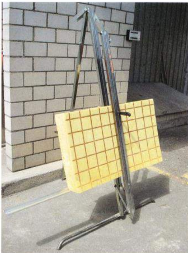
Uređaj za rezanje za termoizolaciju
