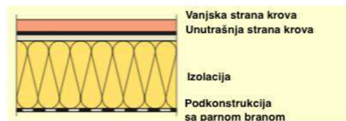
Neprozračeni krov koji sprečava difuziju
