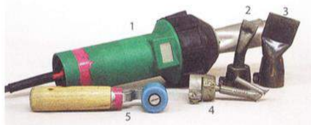
Uređaji za varenje izolacijskih staza od umjetnih materijala
