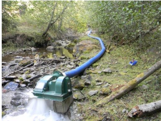
Slika 8. 6. Protočna mikro hidro elektrana
