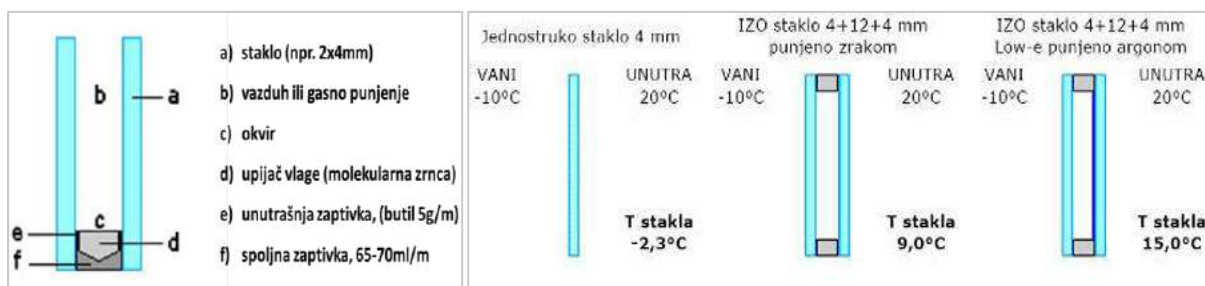
Slika 50. Dijelovi IZO stakla
