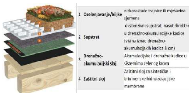
Slika 92. Sistem za ekstenzivno ozelenjavanje krova s nagibom 5 - 15°
