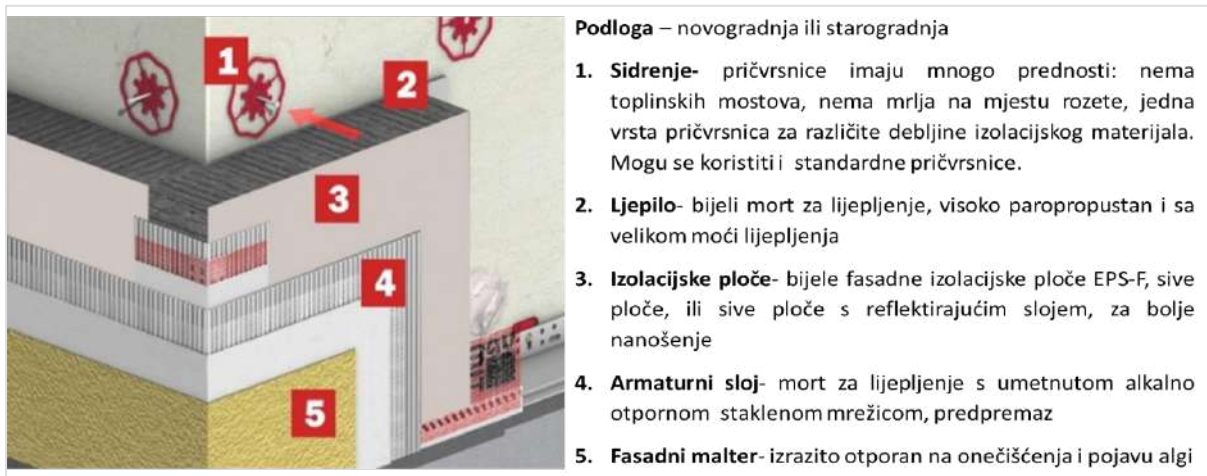
Slika 33. Toplotno-izolacijski sistem povezan polistirenom
