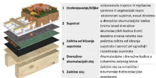
Slika 93. Sistem za ekstenzivno ozelenjavanje krova s nagibom 15 - 25°
