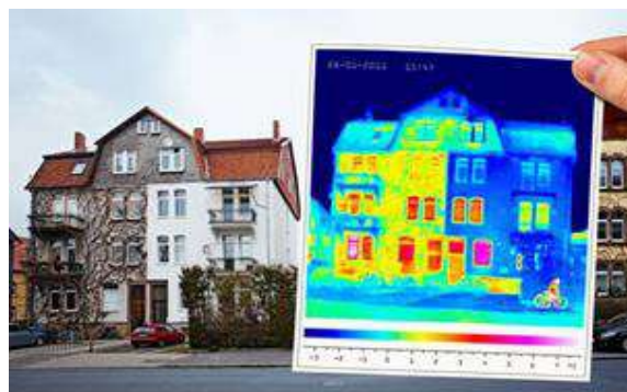
Slika 56. Snimak objekta IC kamerom
