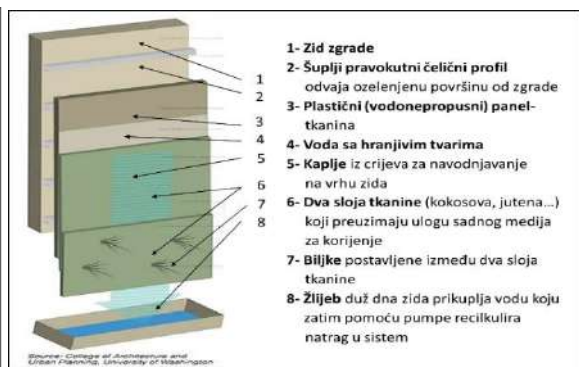
Slika 80. Šematski prikaz slojeva kontinuiranog sistema živećeg zida
