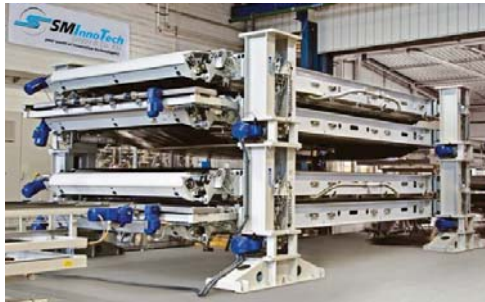
Slika 66: Laminiranje ćelija u modul www.sm-innotech.de
