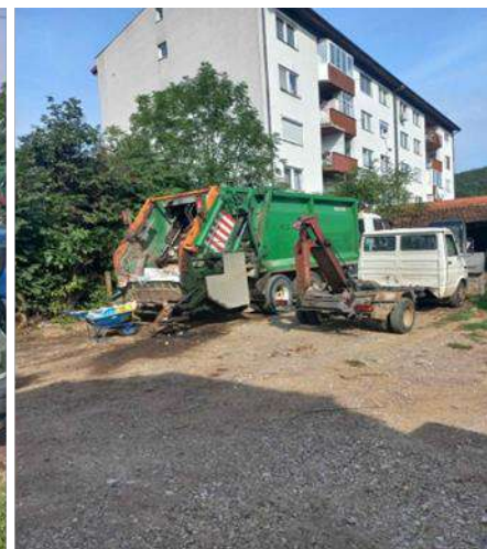
Slika 9: Kamion SKANIJA sabijač 25 t, Kamion IVECO, nosač kontejnera za kabasti i krupni otpad 10 t
