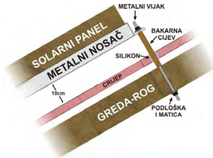
Slika 2.12. Principijska šema postavljanja jednog panela na krovu
