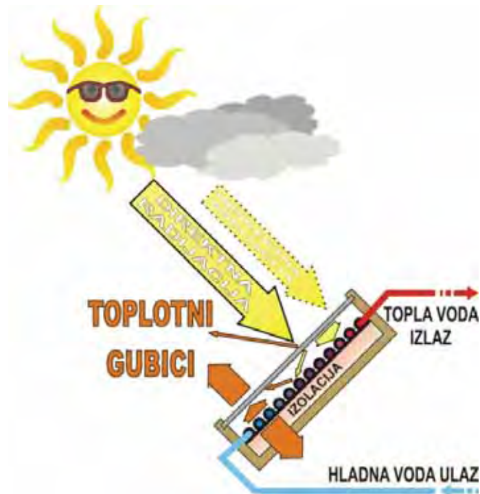
Slika 2.1. Princip funkcioniranja pločastog solarnog kolektorskog panela
