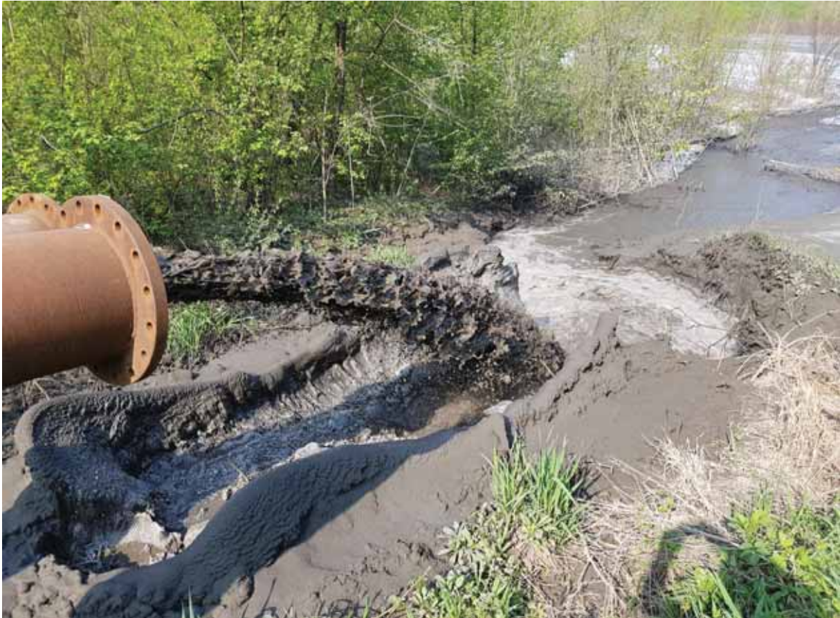
Slika 2.4. Hidraulični transport šljake i pepela - odlagalište Jezero II
