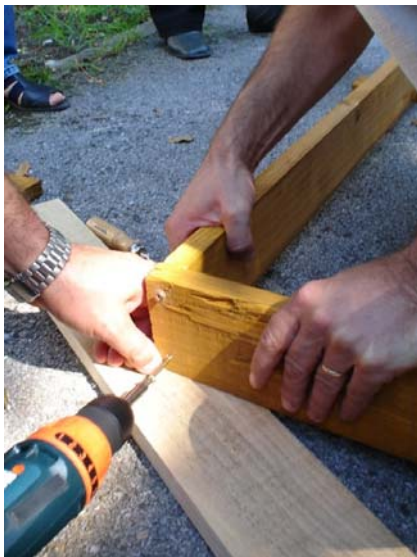
Slika 4.4. Učvršćivanje bočnih strana kućišta
