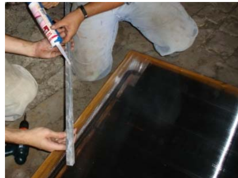
Slika 4.42. Silikonom namazati i L-profile
