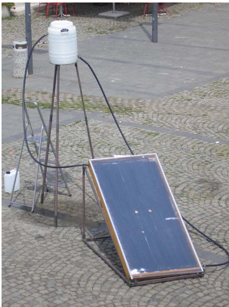
Slika 6.3. Pasivni solarni kolektor u funkciji
