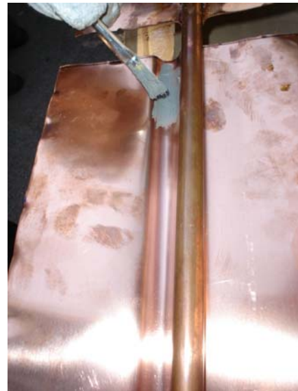
Slika 4.26. Priprema lemljenja bakarnih krila za cijevi
