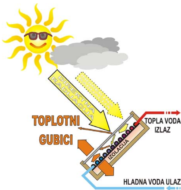
Slika 4.2. Princip funkcioniranja solarnog panela
