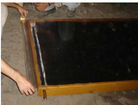
Slika 4.40. Ljepljiva traka sprječava ulazak prašine
