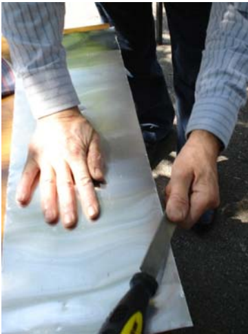
Slika 4.23. Turpijanjem ivica se stitimo od mogućih povreda
