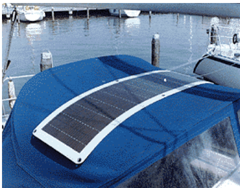
Slika 3.20. Solarno napajanje radio uređaja na brodu
