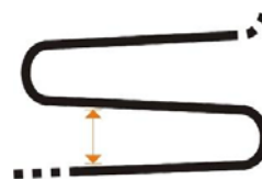
Slika 6.10. Razmak savijenih cijevi je 12-17 cm
