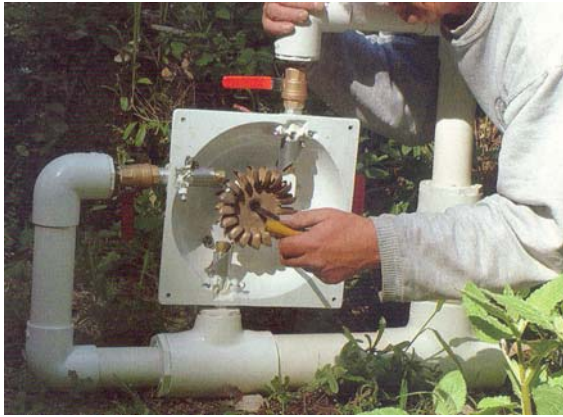
Slika 3.3. Primjer mikro-hidro turbine
