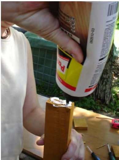
Slika 4.3. Lijepljenje bočnih strana
