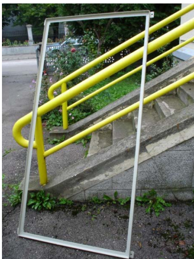
Slika 5.2. Krovno čelično kućište za solarni panel
