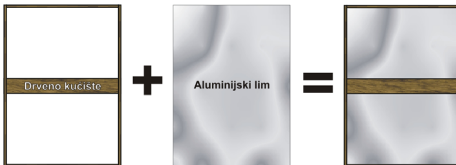
Slika 4.10. Drveno kućište i aluminijski lim sačinjavaju kućišta panela
