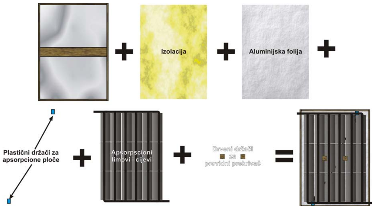
Slika 4.30. Principna šema kompletiranja solarnog panela
