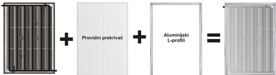
Slika 4.37. Postavljanje polikarbonatne providne ploče na solarni panel
