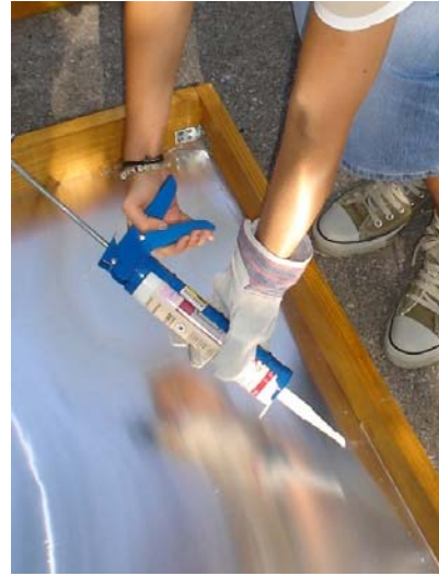
Slika 4.8. Nanošenje silikona na kućište
