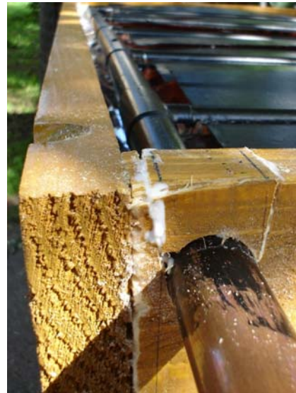
Slika 4.35. Lijepljenje oko ulazno/izlaznih cijevi
