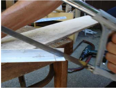
Slika 4.38. Priprema aluminijskih L-profila
