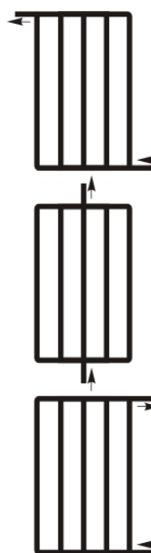
Slika 6.6. Nekoliko varijanti paralelnog spajanja cijevi
