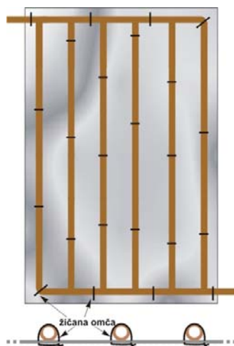
Slika 6.12. Spajanje cijevi za lim pomoću žičanih omči
