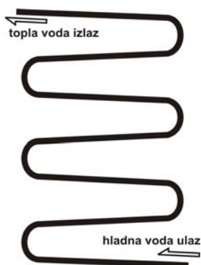
Slika 6.7. Od jedne cijevi se savijanjem napravi željeni oblik
