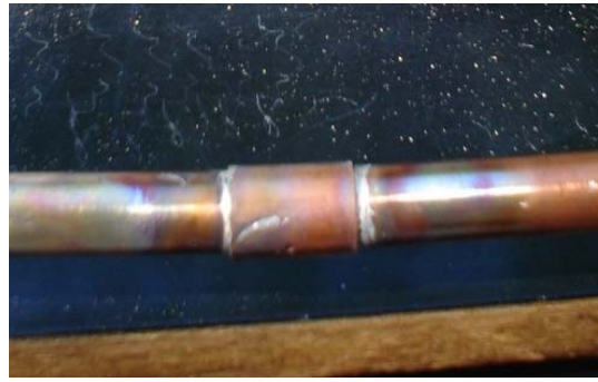
Slika 4.17. Lemljenje radi produžavanja cijevi
