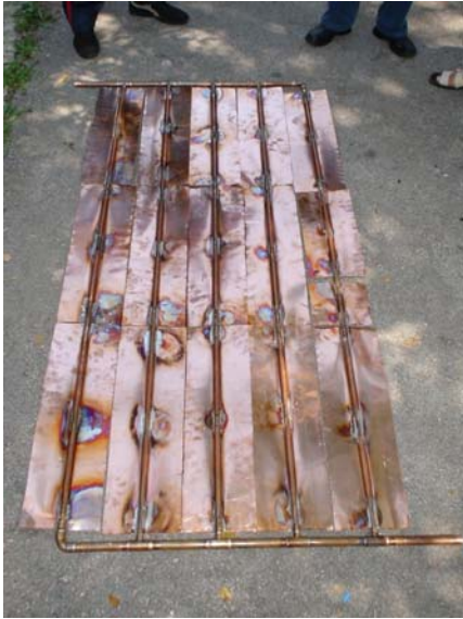
Slika 4.28. Zalemljena krila i cijevi spremni za farbanje
