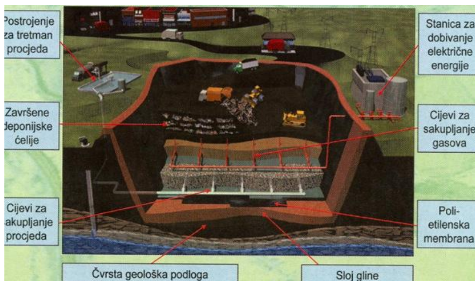
Slika 11. Presjek savremenog odlagališta otpada
